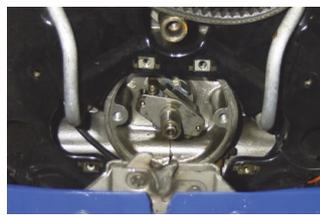
Le boîtier de distribution est derrière. Débranchez le fil du condensateur placé en bas. Le fil qui relie le condensateur à la bobine d'allumage n'est plus nécessaire et vous pouvez le supprimer.
