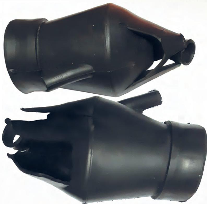
ou pas. Donc ne les mettez jamais au contact de solvants, de produits de protections sous caisse, de cire pour corps creux, de nettoyeurs pour freins, pour jantes ou autres. Evitez aussi le nettoyage haute-pression et n'utilisez aucun nettoyeur chimique pour les pièces en caoutchouc du circuit hydrauliques!
